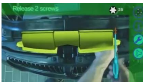
Figura 6. Realidade Aumentada no procedimento para desapertar 2 parafusos [10].
