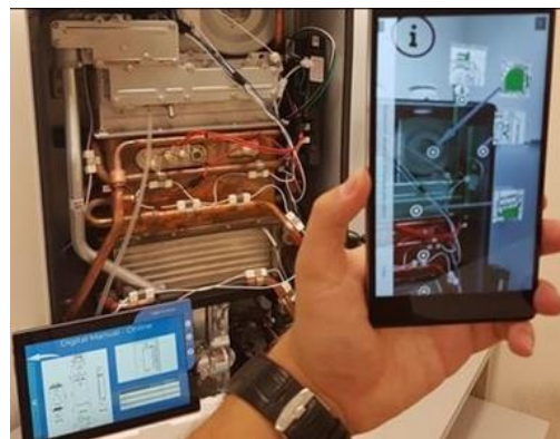
Figura 4. Visualização dos componentes da caldeira [9].
