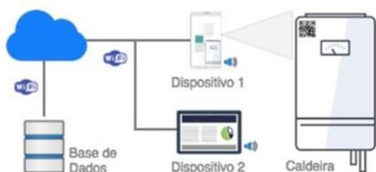
Figura 5. Apresentação da arquitetura proposta para a realização da manutenção utilizando dois dispositivos interligados [9].
